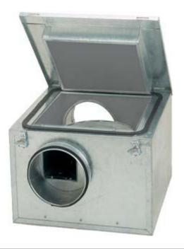
Gehäuse aus verzinktem Stahlblech, doppelwandige Ausführung mit 50 mm Schalldämmung, Ansaug- und Ausblasstutzen mit Gummilippendichtungen zum Anschluss an Normrohre, Deckel zu Revisionszwecken abnehmbar, Ausblasstutzen nach oben oder seitlich versetzbar, Freilaufende, vorwärts gekrümmte Radiallaufräder, dynamisch ausgewuchtet nach DIN 1940, Asynchrone Käfigläufermotoren aus Aluminiumspritzguss mit geschlossenen, wartungsfreien Kugellagern, Schutzart IP 55, Isolierklasse F.
