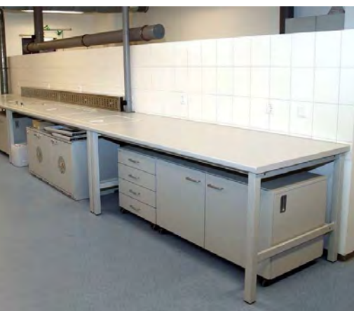
Fotos unten: Labormöbel aus Holz mit Melaminharzbeschichtung
