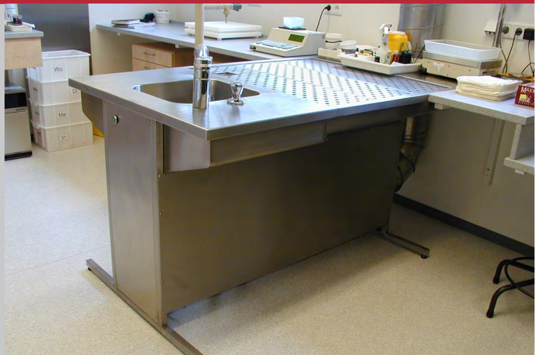
Fotos oben (von links nach rechts): Sicht in die Nasspräparateschränke, Zuschneidetisch UCS-1500 mit Absaugung nach unten.
