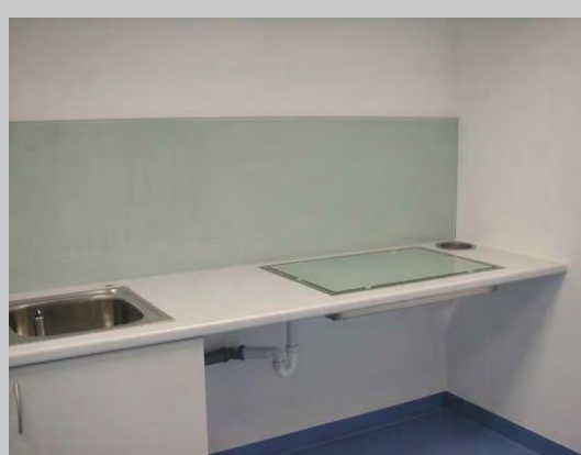
Fotos oben (von links nach rechts): doppelter Gewebezuschnittetisch mit Beleuchtungsaufbau und Absaugung nach unten, Labortisch aus Holz mit Melaminharzbeschichtung und Glasplatte, Formalinentsorgungsstation für Altformalin
