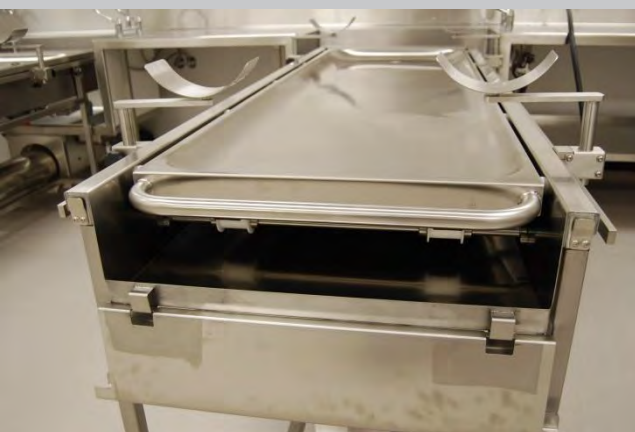
Foto oben rechts: fahrbarer Leichenkonservierungstank aus Edelstahl
