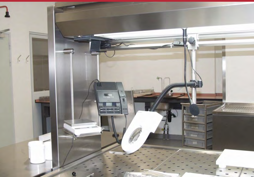
Fotos oben (von links nach rechts): Zubehör am UCS-E-2000-B montiert: Halterungen für Waage, Diktiergerät, Lupenleuchte und Dokumente
