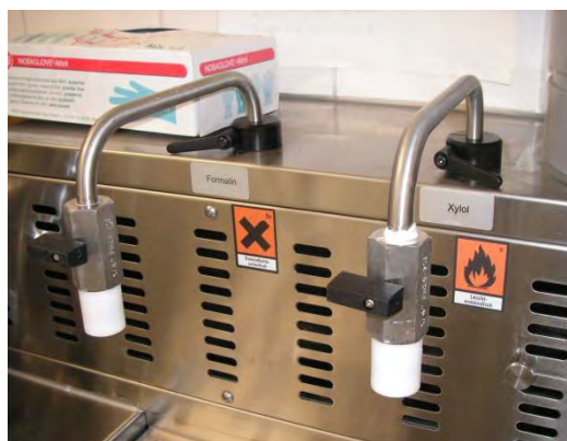
Fotos oben (von links nach rechts): Formalindispensanlage, Ausgabebehne fr Formalin, Xylol und Alkohol, Kontrollschalter mit "NOT-AUS" Taster (rechtes Foto oben rechts im Bild)
