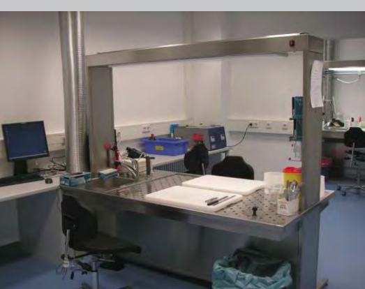
Fotos oben (von links nach rechts): doppelter Gewebezuschnittetisch mit Beleuchtungsaufbau und Absaugung nach unten, Labortisch aus Holz mit Melaminharzbeschichtung und Glasplatte, Formalinentsorgungsstation für Altformalin
