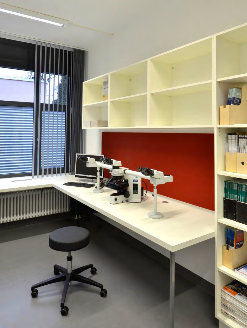
Fotos oben: farblich abgestimmte Labormöbel aus Holz mit Melaminharzbeschichtung
