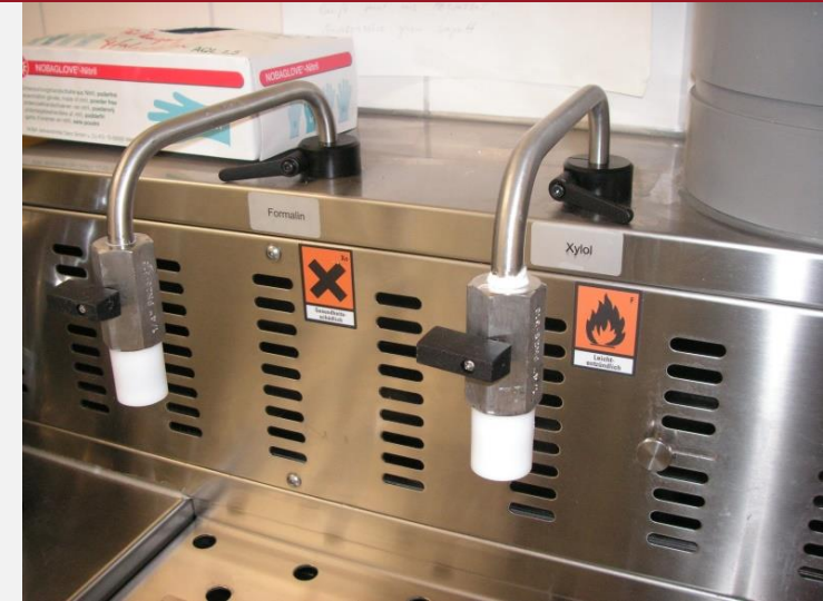
Entnahmehähne für Formalin, Xylol und Ethanol
