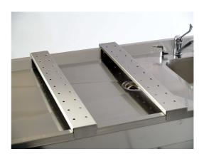
Die Körperstützen sind komplett aus Edelstahl (Material Nr. 1.4301 – ANSI 304) gefertigt. Stabile Profilblechkonstruktion aus 2 mm gebürstetem Edelstahl 100 x 20 mm, links und rechts mit je einer Abkantung zur seitlichen Fixierung am Seziertisch.
