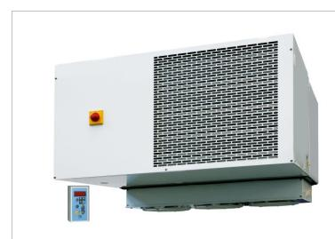
Das stabile Gehäuse ist mit einem geräuscharmen, vollhermetisch, luftgekühlten Verdichter ausgestattet. Sicherheitseinrichtungen sind gemäß EN (DIN)-Normen VDE-Vorschriften und VBG-Richtlinien ausgeführt. Hochleistungsverdampfer mit automatischer Abtauung, elektrische Temperaturregelung, digitale Temperaturanzeige mit Anschlussleitung und Schukostecker. Kältemittel: R 134A
