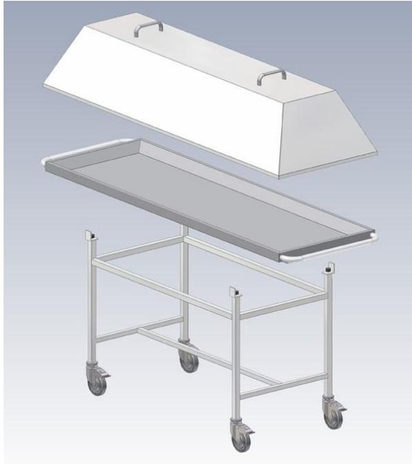
Die Stabile verwindungssteife Rahmenkonstruktion ist komplett aus Edelstahl (Material Nr. 1.4301 – ANSI 304) gefertigt. Der Transportwagen ist mit 4 Lenkrädern, 2 feststellbar, 1 richtungsfeststellbar  $d = 125$  mm ausgestattet. Die Räder mit Spezialkugellagern, dauergeschmiert und wartungsfrei, sorgen für einen leichten geräuschfreien Lauf. Der Oberaufbau ist mit 4 Gummipuffern zur Aufnahme einer Leichenmulde versehen.
