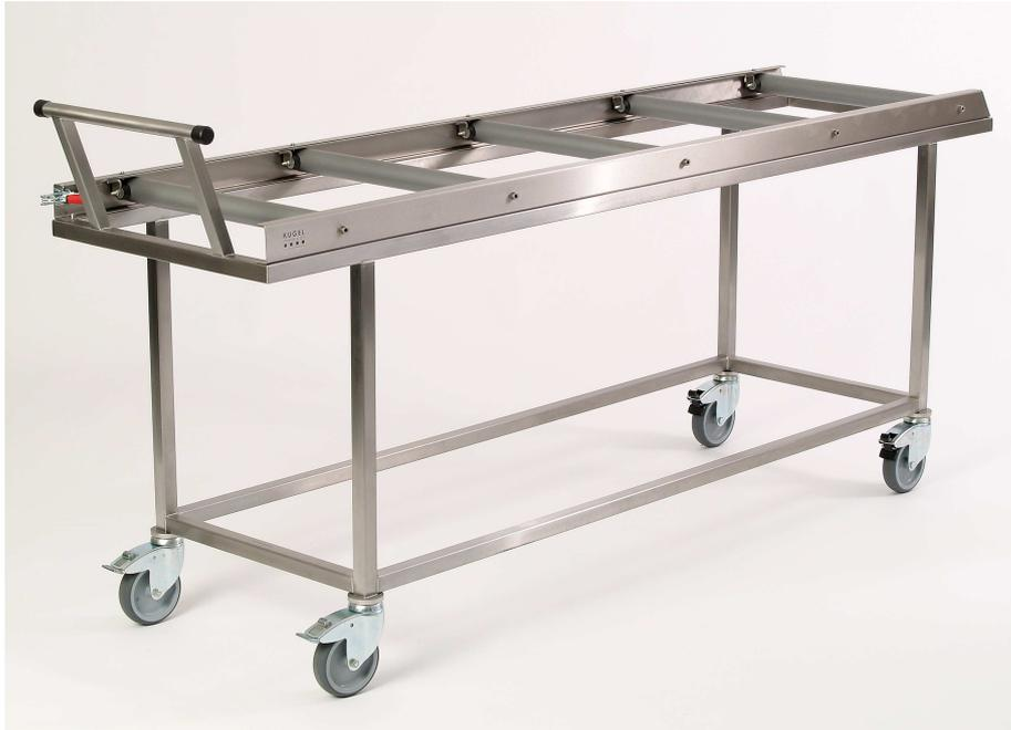
Die Stabile verwindungssteife Rahmenkonstruktion ist komplett aus Edelstahl (Material Nr. 1.4301 – ANSI 304) gefertigt. Der Transportwagen ist mit 4 Lenkräder, 2 Stück feststellbar, 2 Stück mit Richtungsfeststeller  $d = 125$  mm mit Spezialkugellager, dauergeschmiert und wartungsfrei, ausgestattet. Der Oberaufbau ist mit einer Rollbahn aus Edelstahl mit 5 Tragrollen sowie Haltevorrichtung für Leichenmulde. Der Schiebebügel ist fest angeschweißt.
