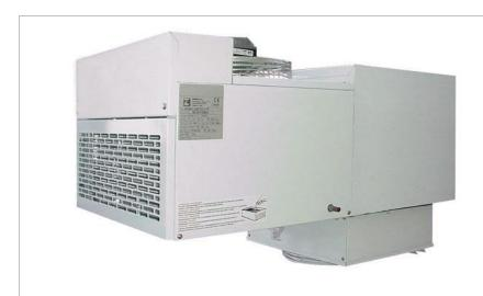
Das stabile Gehäuse ist mit einem geräuscharmen, vollhermetisch, luftgekühlten Verdichter ausgestattet. Die Sicherheitseinrichtungen sind gemäß EN (DIN)-Normen VDE-Vorschriften und VBG-Richtlinien ausgeführt. Hochleistungsverdampfer mit automatischer Abtauung, elektrische Temperaturregelung, digitale Temperaturanzeige mit Anschlussleitung und Schukostecker. Umgebungstemperaturen: +5°C bis +45°C
